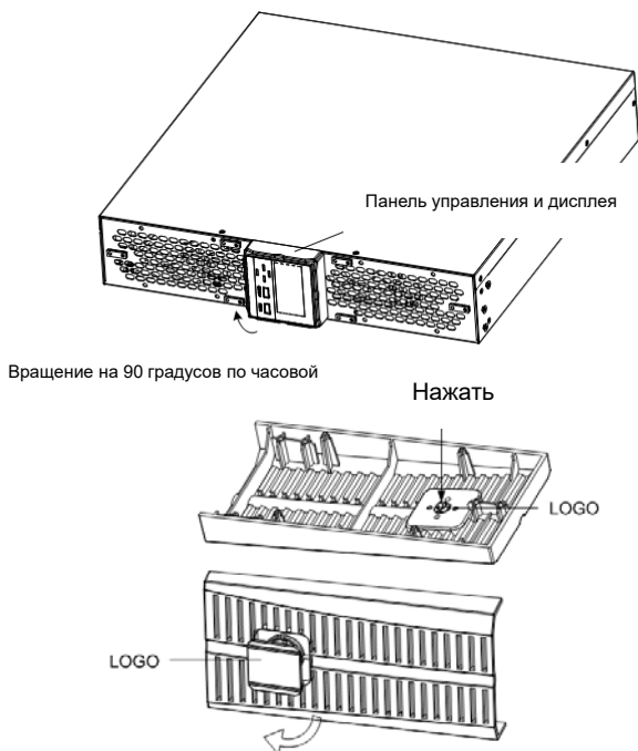
Рис. 2- 3: Вращение панели управления и дисплея
