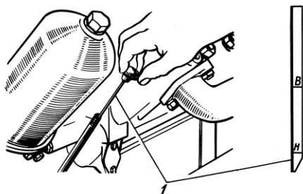
Рис. 60. Проверка уровня масла в картере двигателя:
