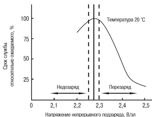
Рис. 8 Зависимость срока службы аккумулятора от напряжения подзаряда
