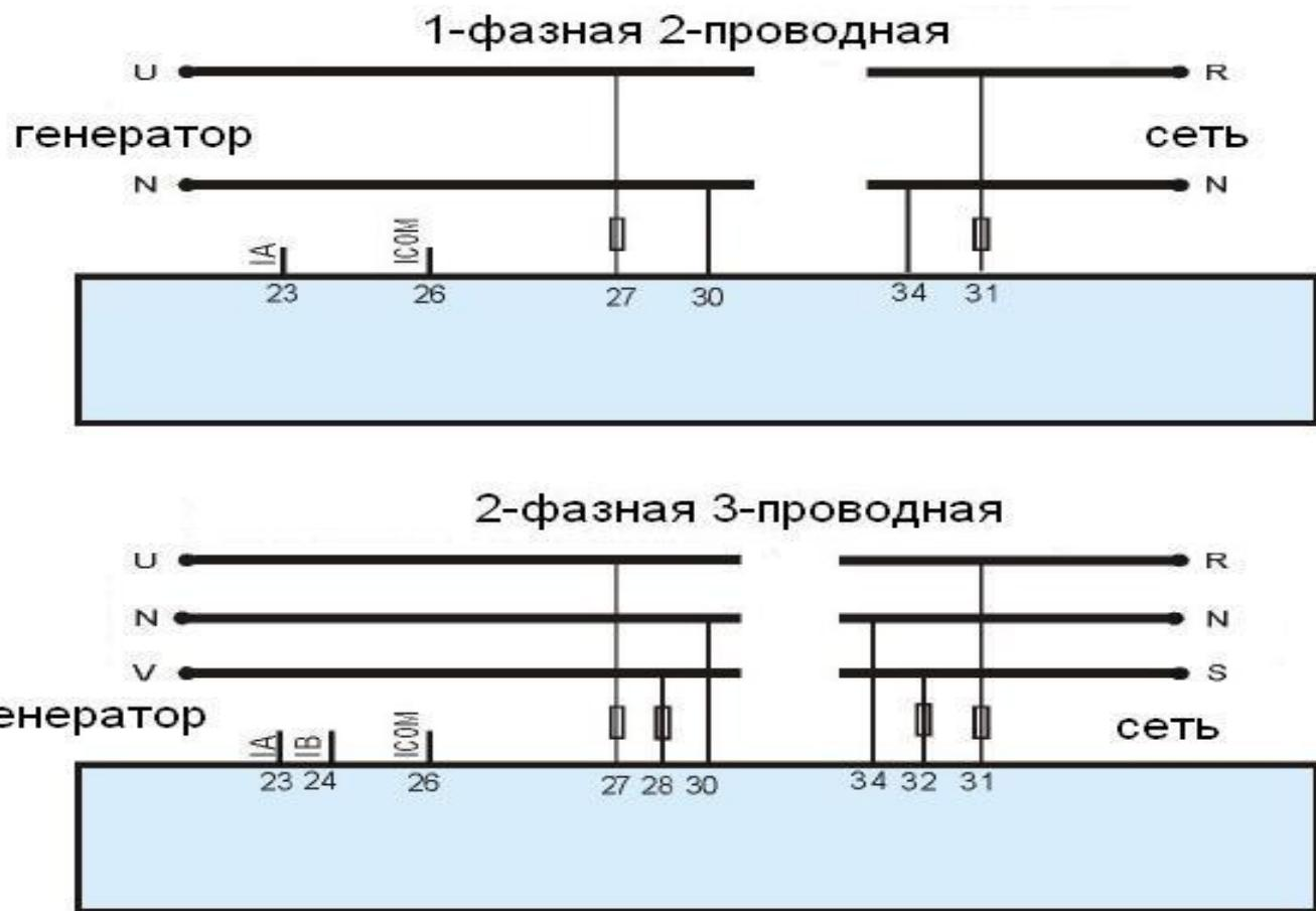
Подключение контроллеров Smartgen HGM6120K/KC, HGM6120U/UC и HGM6120N/NC/CAN
