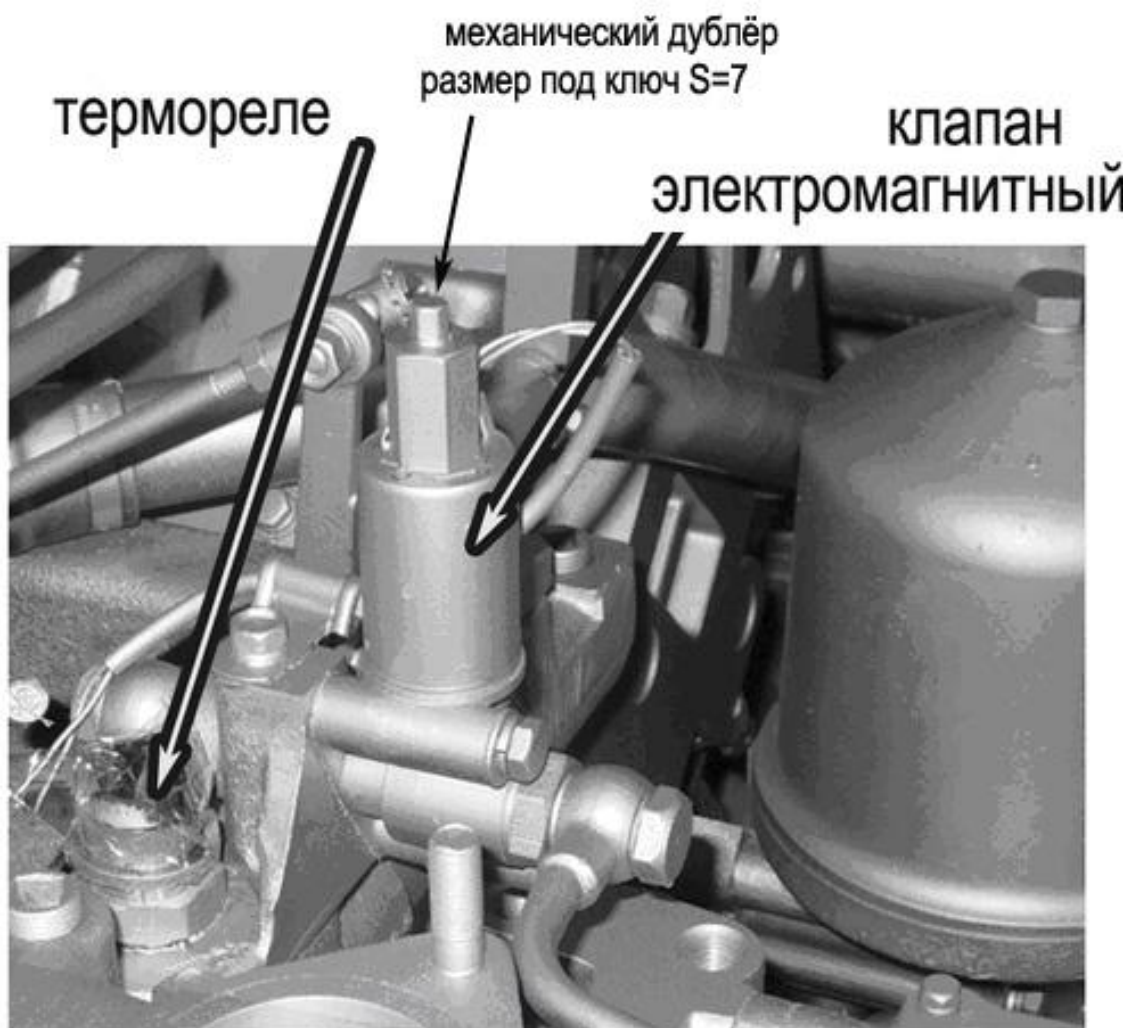
Устройство включения привода вентилятора
