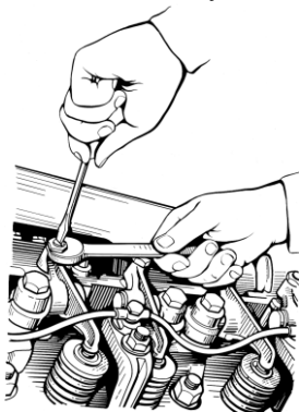
Рис. 16. Отвертывание контргайки регулировочного винта
