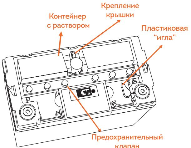
**ШАГ 3:** Проколите иглой защитную мембрану и вставьте в контейнер трубку для долива. Снимите предохранительные клапаны.
