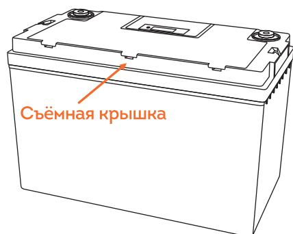
**ШАГ 2:** Выньте 2 заполняющих контейнера и снимите 2 колпачка клапана.
