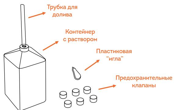
**ШАГ 4:** Мягко залейте раствор во все ячейки в соотношении один контейнер на три ячейки. Избегайте перелива. Закройте предохранительный клапан крышкой, когда наполнение будет закончено.
