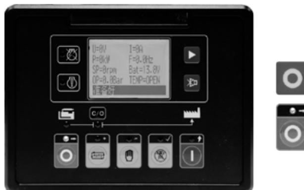
Рис. 5.10 – Основное управление, кнопка останова
